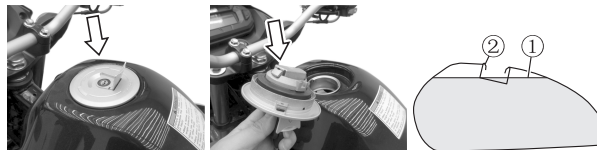
① Nivel de combustible ② Boca de llenado
